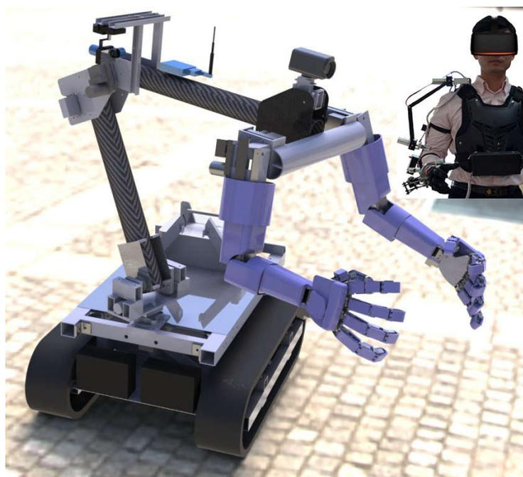
图 22 自主研发的具有仿人手机械臂的反恐救援机器人 a
