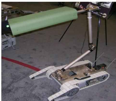
图 16 Packbot 侦察机器人 图 17 携带拉曼侦察装置的 PackBot 机器人
